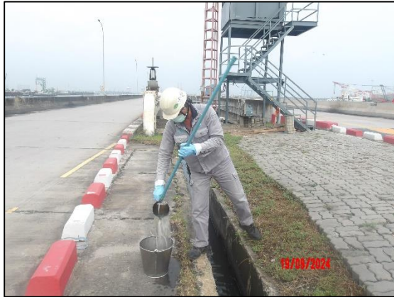
รูปที่ 3.21 การเก็บตัวอย่างคุณภาพน้ำทิ้ง บริเวณน้ำทิ้งที่ออกจากระบบบำบัดน้ำเสียของอาคารสำนักงานบริหารท่าเทียบเรือและคลังสินค้าบนฝั่ง
